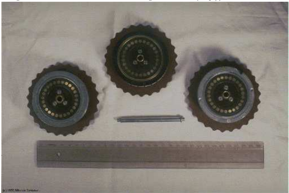
Figuur 3.2: Foto van de rotors van de enigma-machine ( http://www.math.arizona.edu/dsl/images/enigma50.gif )
